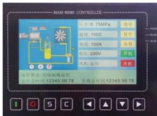
節能螺桿空氣壓縮機的操作介面
